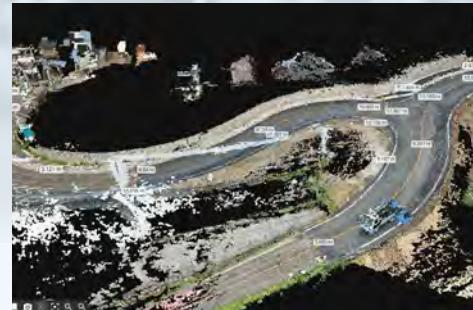
モバイル計測ツールを活用した道路台帳平面図作成
