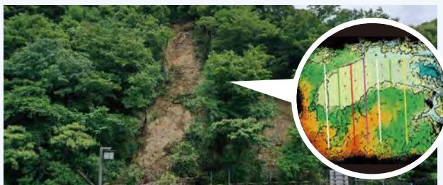
災害箇所のUAV・TLSでの地形図作成
